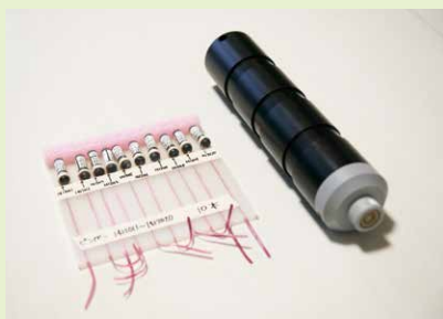
ピンガーと受信機 受信機から500m範囲内にある標識魚の情報を取得でき、受信したデータはほぼリアルタイムで見ることができます。
