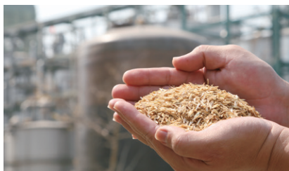
バイオマスコジェネレーションシステムで使用するもみ殻
