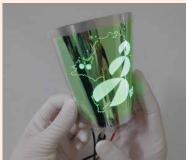
AEFを使った有機ELは曲げることも可能 ※この技術は、(公財)九州先端科学技術研究所と共同開発しています
