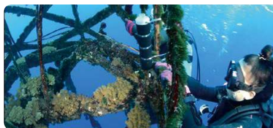
受信機を魚礁などに設置する作業。受信機近辺を回遊するカツオのデータを取得する
