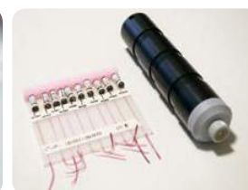
ピンガー(超音波標識)と受信機
