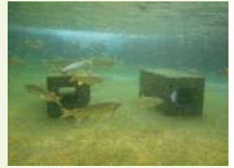
通常のコンクリート(右)と比べ、魚が群がる環境活性コンクリート(左)
